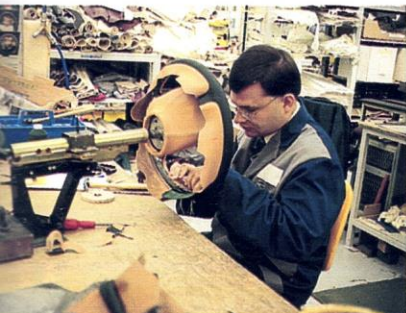
Abwechslungsreiche Arbeitswoche in den heiligen Hallen britischer Ingenieurskunst: Starproduzent Dennis Jones (Foto ganz rechts) zeigt Peter Keist, wie der markante Kühler eines Rolls-Royce (siehe auch grosses Bild links) zusammengelötet wird.
