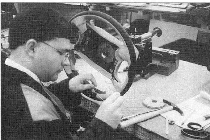
Montieren des Lederkranzes an einem Bentley Steuerrad
