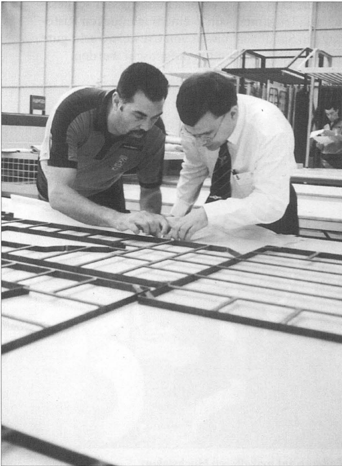
Mittels Lehren wird das Leder für die Sitzbezüge ausgestanzt
